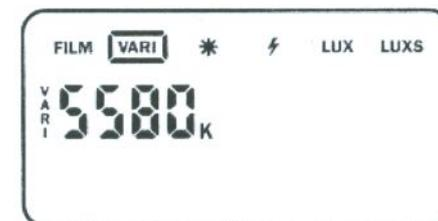
(Si, après avoir réglé la température de couleur, on sélectionne la fonction de mesure en lumière continue ou en lumière-flash, les valeurs de filtrage de la dernière mesure sont adaptées automatiquement à la nouvelle valeur de température de couleur du film.)
