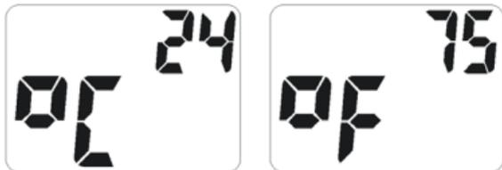
Der **Digiflash** zeigt jetzt die aktuelle Umgebungstemperatur an. Der Temperaturfühler ist im Gehäuse integriert. Durch Halten des Gerätes in der Hand beeinflussen Sie die Temperaturmessung. Um Messfehler zu vermeiden befestigen Sie Ihren **Digiflash** mittels Aufsteckschuh an Ihrer Kamera.
