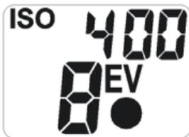
Bei einer Veränderung der Filmempfindlichkeit wird das letzte Messergebnis automatisch umgerechnet. Die gewählte Filmempfindlichkeit bleibt so lange gespeichert, bis sie auf die eben beschriebene Weise geändert wird. Die eingestellte Filmempfindlichkeit gilt sowohl für Blitz- als auch für Dauerlicht.
