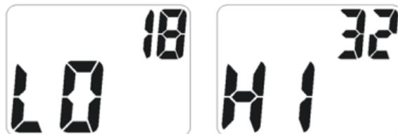
Löschen des Minimum- und Maximum-Temperaturspeichers durch Drücken der Messtaste bis der Bestätigungston ertönt. Die Temperaturmessung wird automatisch alle 2 Minuten aktualisiert. Mit der Minimum- und Maximum-Temperaturmessung können Sie überprüfen, ob Ihr Filmmaterial zu hohen Temperaturen ausgesetzt war und somit geschädigt wurde.
