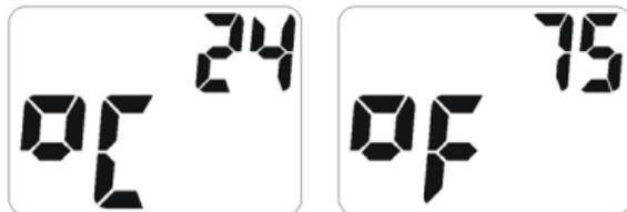
Der **Digisix** zeigt jetzt die aktuelle Umgebungstemperatur an. Der Temperaturfühler ist im Gehäuse integriert. Durch Halten des Gerätes in der Hand beeinflussen Sie die Temperaturmessung. Um Messfehler zu vermeiden befestigen Sie Ihren **Digisix** mittels Aufsteckschuh an Ihrer Kamera.
