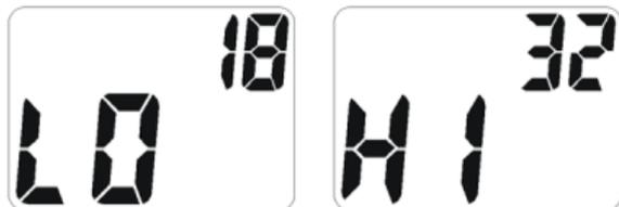
Löschen des Minimum- und Maximum-Temperaturspeichers durch Drücken der Messtaste bis der Bestätigungston ertönt. Die Temperaturmessung wird automatisch alle 2 Minuten aktualisiert.
