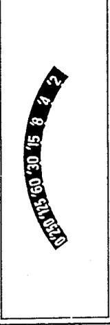
2 '4 '8 usw. sind Sekunden-Bruchteile, d. h. 1/2 - 1/4 - 1/8 Sek. usw. Unbenannte Zahlen 1, 2, 4 usw. sind ganze Sekunden. 1<sup>m</sup> 2<sup>m</sup> 4<sup>m</sup> usw. bedeuten 1, 2, 4 usw. Minuten. 1<sup>h</sup> 2<sup>h</sup> bedeuten 1, 2 Stunden.
