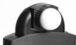
La mesure en lumière incidente permet une détermination exacte de l'exposition : le DIGIPRO F2 coiffé du diffuseur est dirigé depuis le sujet vers l'objectif et mesure donc la lumière tombant sur le sujet, garantissant ainsi un rendu fidèle des couleurs et des valeurs de gris. Ceci revêt une grande importance pour les sujets clairs ou sombres.
