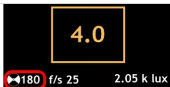
Die Sektorenwinkel von 45° bis 315° können eingestellt werden. Die Einstellung erfolgt in 5°-Stufen.
